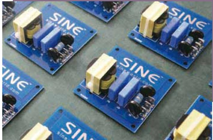
磁場強度和磁通密度，也要經過精密計算和配合，才能得出最佳的效果。SINE S20A 另外一個特性是在「補償卡」上併上一支西門子防雷管，由於只是併上，所以不會影響電流的流動，但當出現異常而有害的大電流時，防雷管便發生作用，把其轉化為光導走，在不影響聲音效果之餘，也有高度的安全性。SINE 的電源處理器能夠暢銷於對電器產品安全度有甚高要求的歐洲，這個特別的設計是必不可少的。
